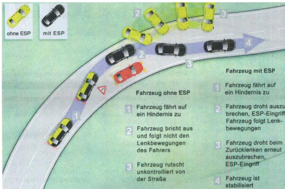
Paradebeispiel einer Rettung durch das elektronische Stabilitätsprogramm an Bord. (Fotos: Bosch)
