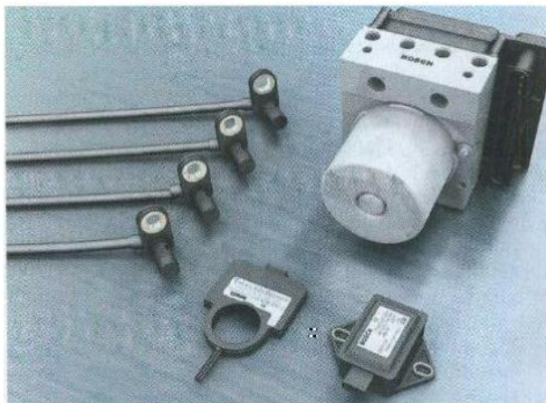
Das braucht für ESP: Raddrehzahlsensoren, Lenkwinkelsensor, Drehraten-/Querbeschleunigungssensor, Hydroaggregat für gezielte Bremsstösse mit gekoppeltem Steuergerät.
